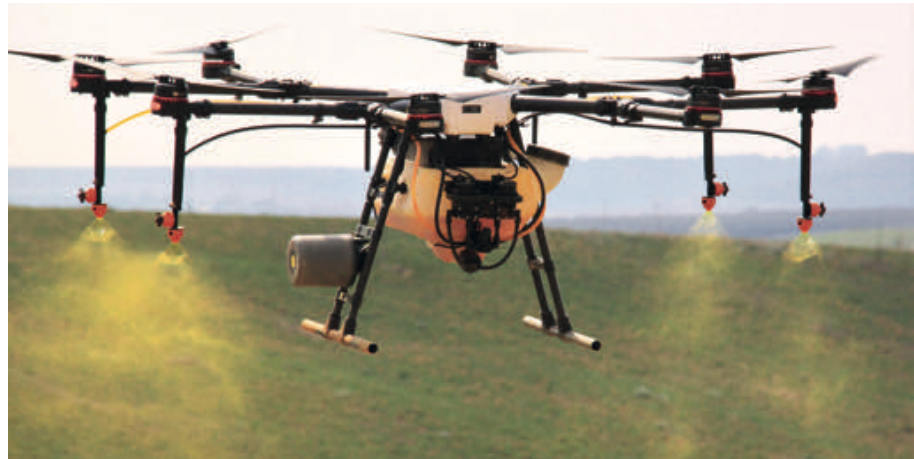
Foto 2. Dron fitosanitario operando en los ensayos de evaluación realizados por el Grupo Operativo Phytodron en Raimat (Planas, 2022).
