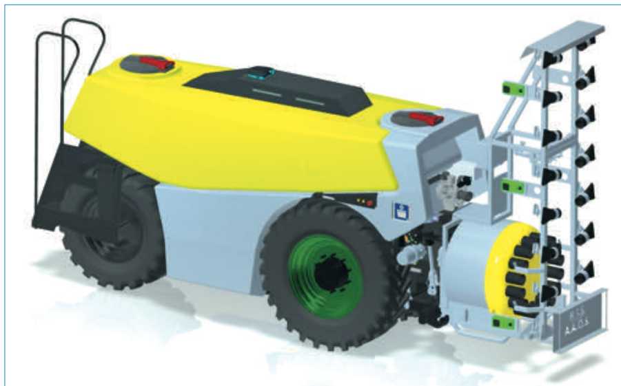
FIG. 3 Vehículo autónomo adaptado a la pulverización de plantaciones AgBot (H.S.S. & AgXeed) 3 .
