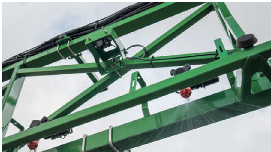
Foto 1. Sistema See and Spray™ incorporando cámaras de detección y boquillas de actuación individual (John Deere) 2 .
