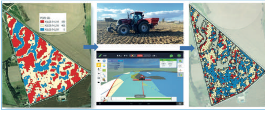
FIG. 1 Fertilización variable de precisión basada en mapa de rendimientos e imagen satelital (Agrarium).
