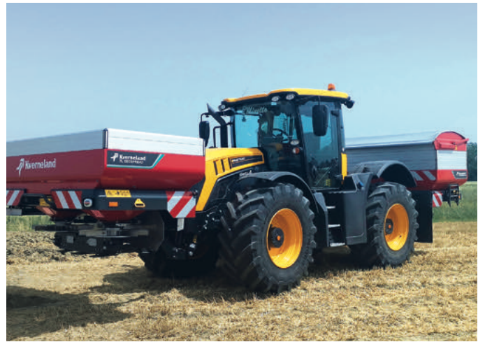
Foto 8. Tractor JCB Fastrac con equipo de abonado en elevador delantero y trasero.
