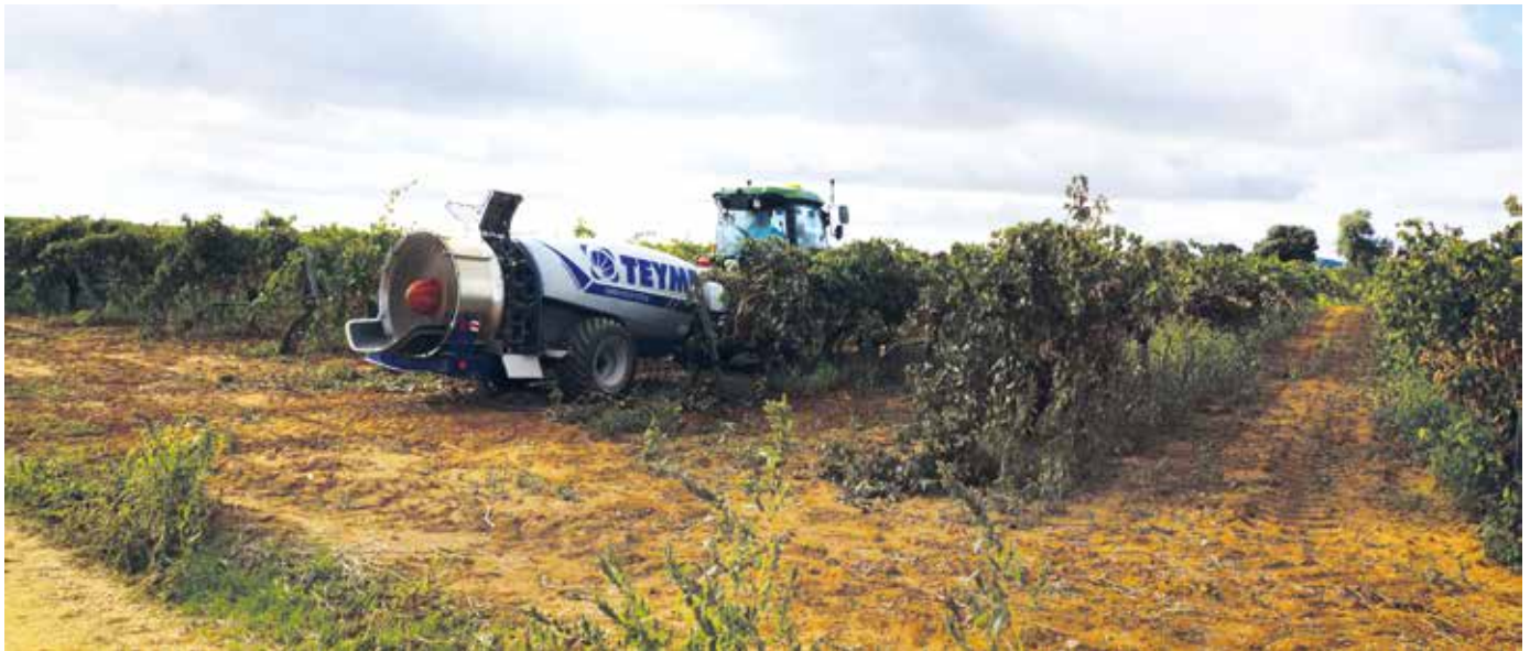
Smart Apply está instalado de manera combinada en un atomizador Teyme Eolo GTE10 dotado de tecnología Isobus.
