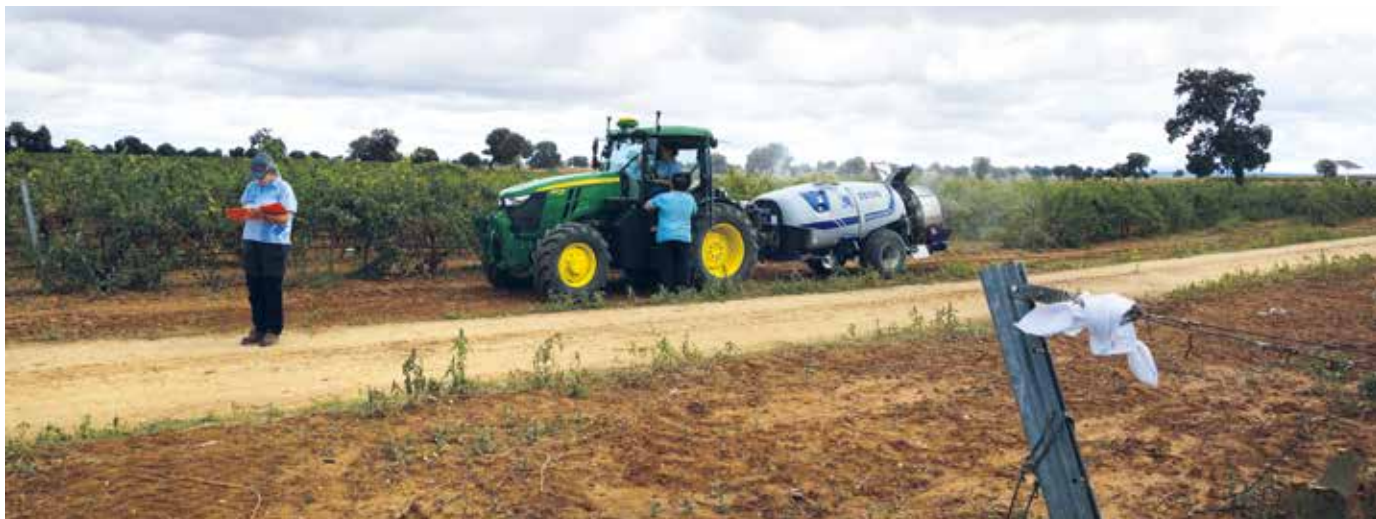
Prueba de campo realizada en la finca El Socorro del Imidra para obtener la información que se visualiza en el terminal del sistema Smart Apply, comparándola con los registros manuales de volumen de vegetación.
