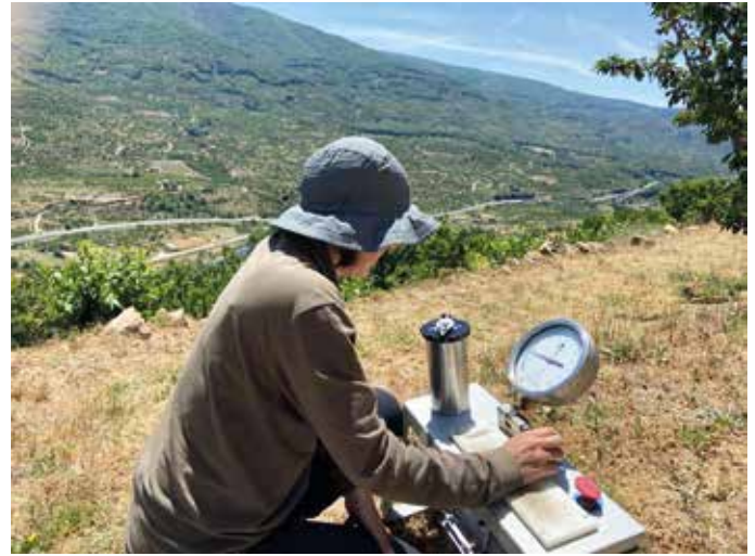
Estación agroclimática instalada en la parcela (Izq.) y medición del potencial hídrico del tallo a mediodía con cámara de presión Scholander (Dcha).
