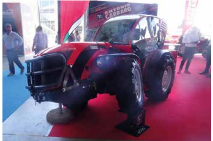
Foto 5. Tractor especialista con articulación del chasis (vertical y horizontal).
