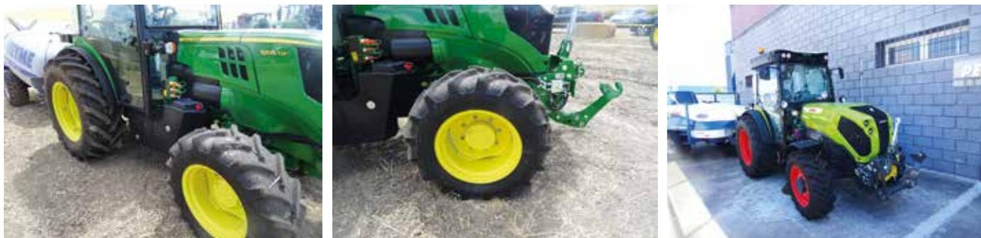
Foto 9. Detalles de los sistemas de acoplamiento: tomas hidráulicas centrales y tripuntal delantero con brazos plegables.
