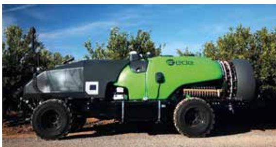
**Foto 13.** Vehículos autónomos equipados con atomizador para plantaciones frutales (Doc. John Deere y Kubota).
