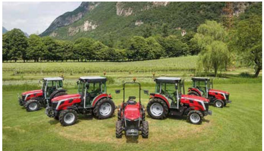
Foto 3. Configuración de una serie comercial de tractores especialistas (de izquierda a derecha): frutero ancho (F), semiestándar, perfil bajo, frutero convencional (F) y viñero (V) (Doc. Massey Ferguson).
